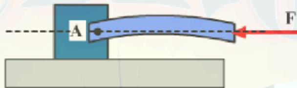
Observa el efecto de curvatura generada por F
